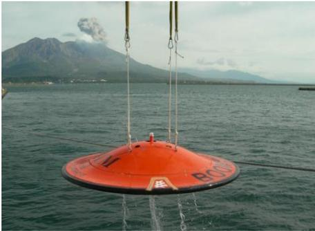
Рисунок 1 – Глайдер дискообразной формы
