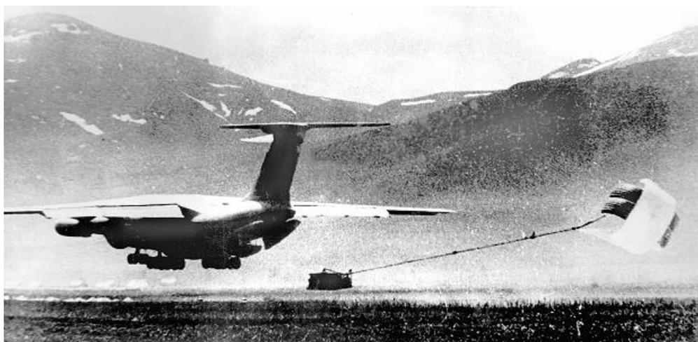
Рис. 9. Технология вытягивания тяжелых грузов из транспортных самолетов
