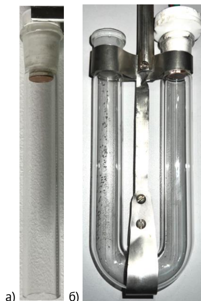
Рис. 1. Экспериментальные образцы а) прямой вертикальный канал; б) U-образный канал
