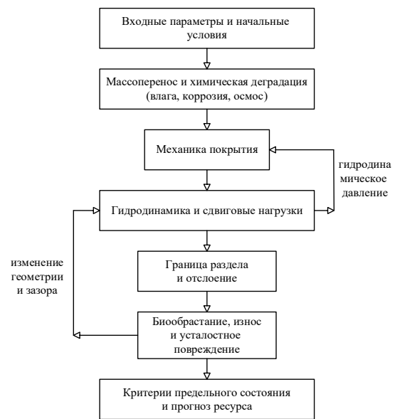
Рис. 1. Схема модели деградации покрытия ледокола
